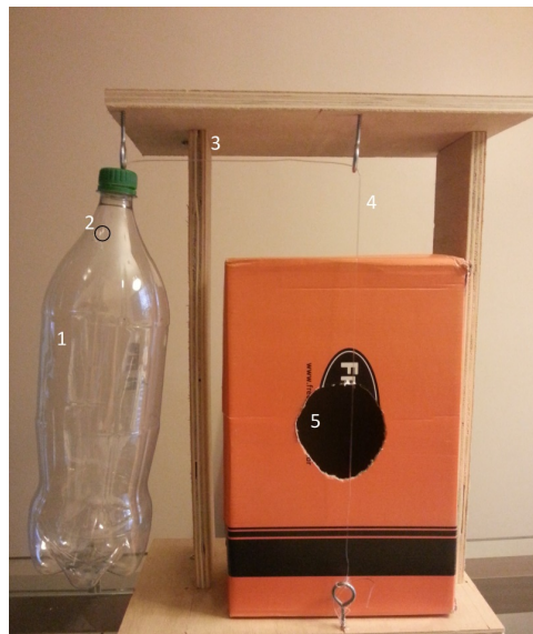
Figura 2: Aparato experimental montado. 1: Reservatório. 2: Orifício lateral para auxiliar o enchimento do reservatório. 3: Estrutura de madeira. 4: Corda de violão. 5: Caixa de ressonância
