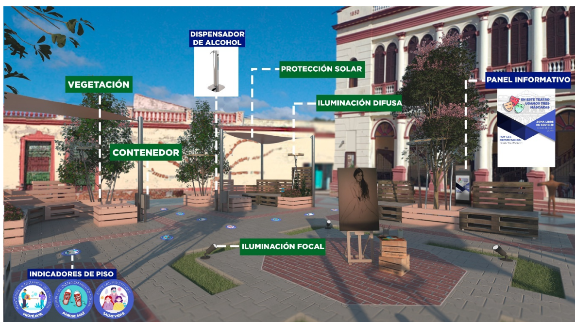
Figura 10 – Resultado del trabajo en equipo interprofesional, principios de diseño y equipamiento urbano para cumplimiento de los protocolos sanitarios
