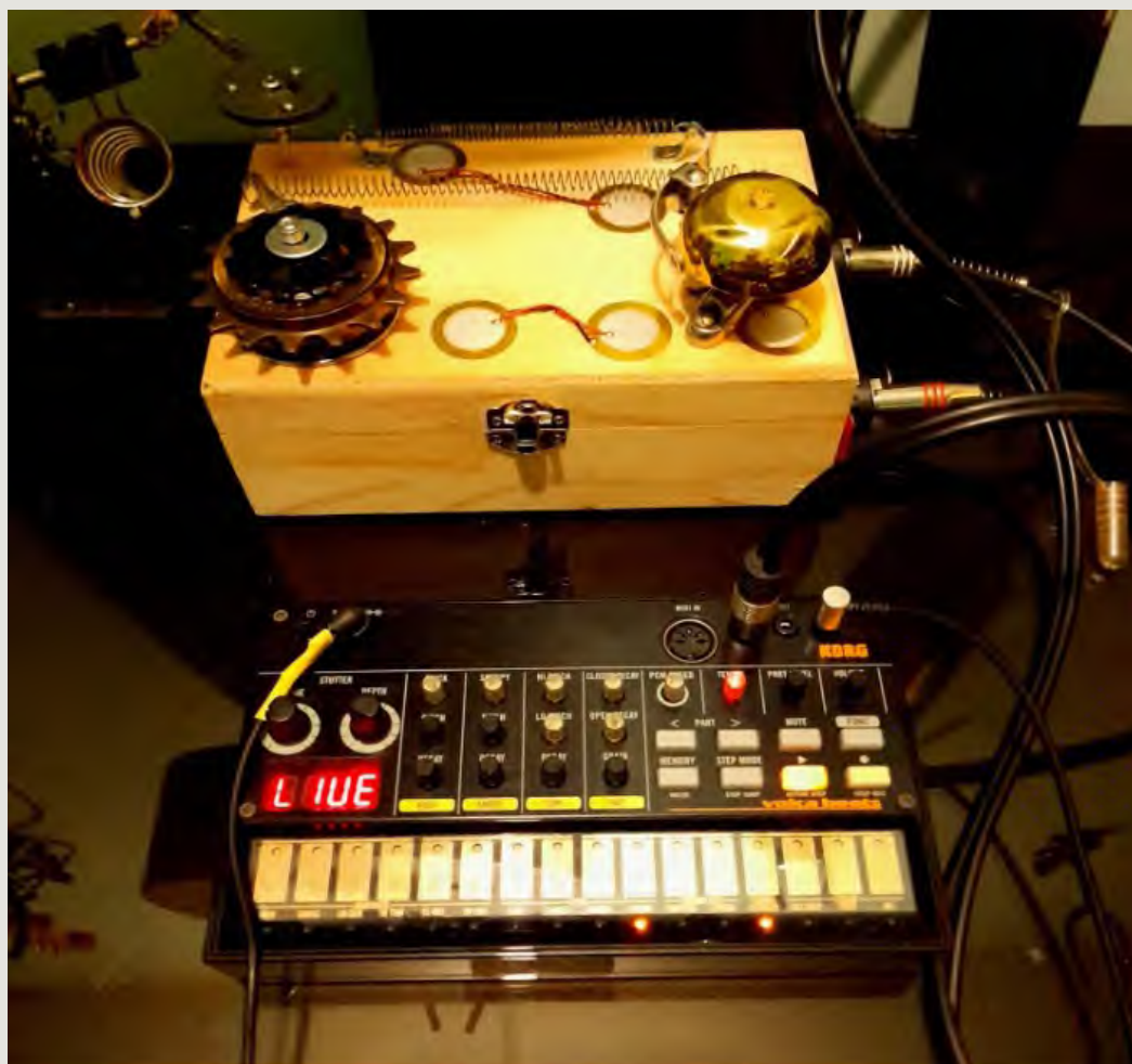
Figura 5 : Noise Box "La Rumorosa" conectada analógicamente ao Synth Volca Beat Korg.
